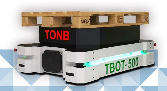
Elimination of the need for environmental modifications or installation of markers for navigation ◄ عدم نیاز به هیچگونه تغییرات محیطی و نصب علائم جهت مسیریابی
